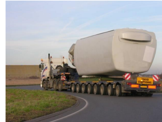
Transport de la nacelle
